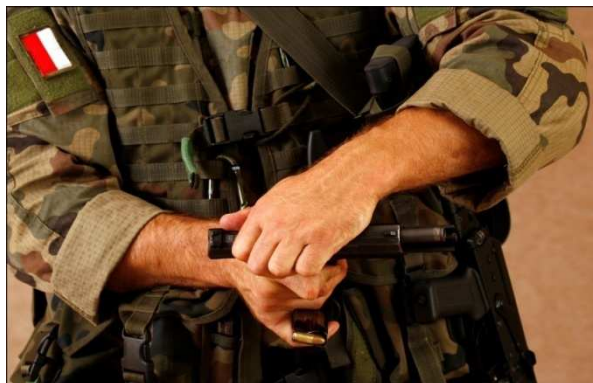
Rys. 79 Zamek przesunięty nachwytem w tylne skrajne położenie zablokować kciukiem ręki dominującej
